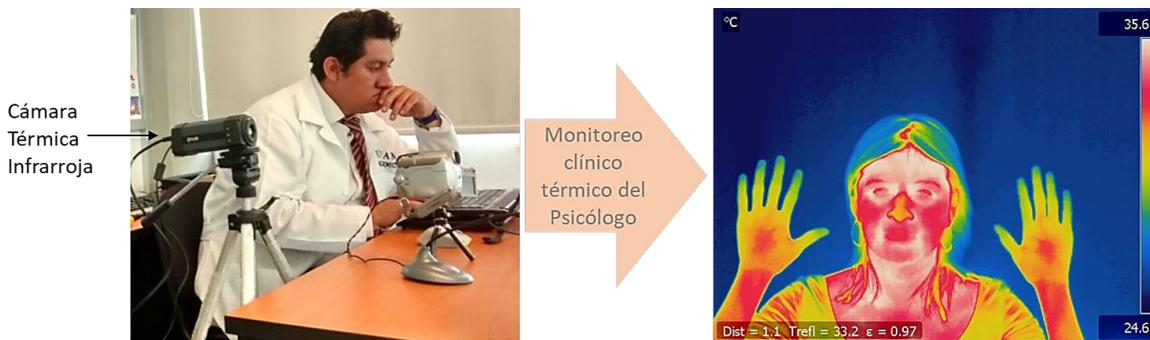
**Fig. 2. RIO faciales y escala de evaluación categórica.** La escala categórica de temperatura va de 0 a 5, con puntos intermedios para su evaluación clínica rápida y continua. Cada valor de 0.5 es aproximadamente 1.2°C. Se muestran las RIO faciales.
